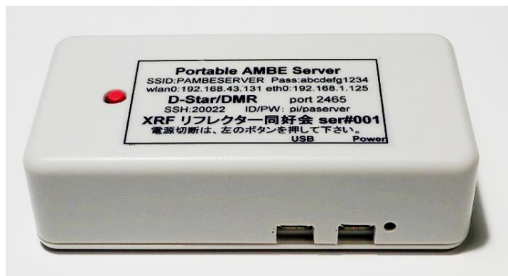
Fot. 12.2.8. Portable AMBE Server składa się z Maliny z dodaną płytką wokodera
