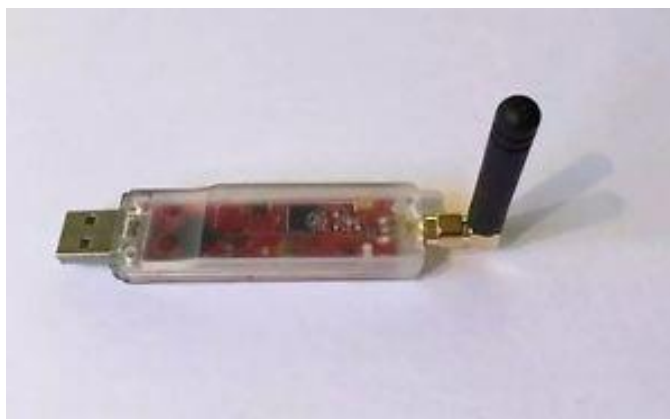
Fot. 11.1. Mikroprzeziennik „DV4mini” umożliwia pracę w systemach D-Star, DMR, C4FM, APCO P25, dPMR i NEXTEEDGE (NXDN). W chwili obecnej dostępne jest oprogramowanie sterujące dla Windows 7–10 i „Maliny”
