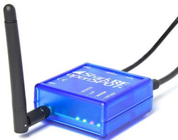
Fot. 11.6. „OpenSpot” pracuje autonomicznie bez konieczności podłączenia go do komputera ale jest wyposażony wyłącznie w złącze „Ethernet”. Pozwala za to na prowadzenie łączności skrótnych C4FM-DMR
