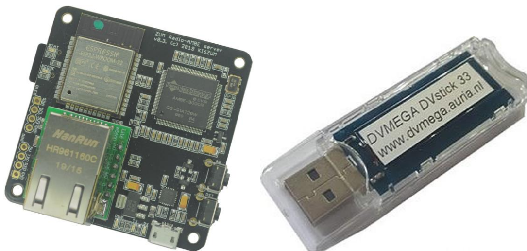
Fot. 12.2.6 (po lewej). Wokoder ZUM-AMBE3000 Fot. 12.2.7 (po prawej). Wokoder USB DVMEGA oparty o AMBE3003
