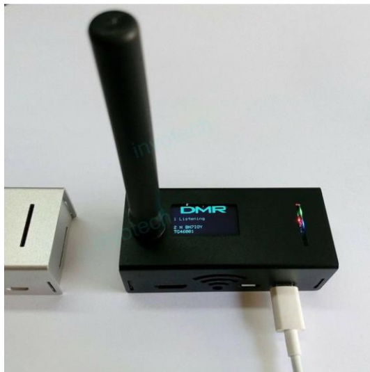
Fot. 11.13. MMDVM korzysta z dostępu do sieci WiFi w standardach 802.11b/g/n
