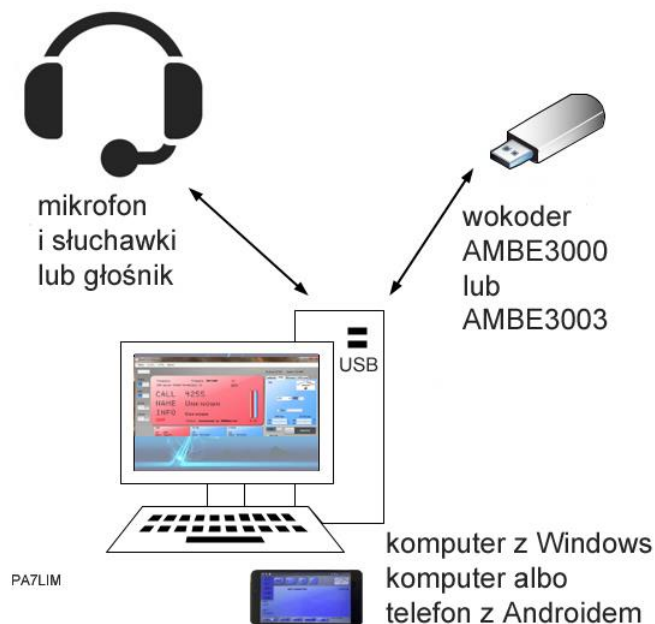
Rys. 12.2.4. Schemat blokowy stacji z BlueDV
