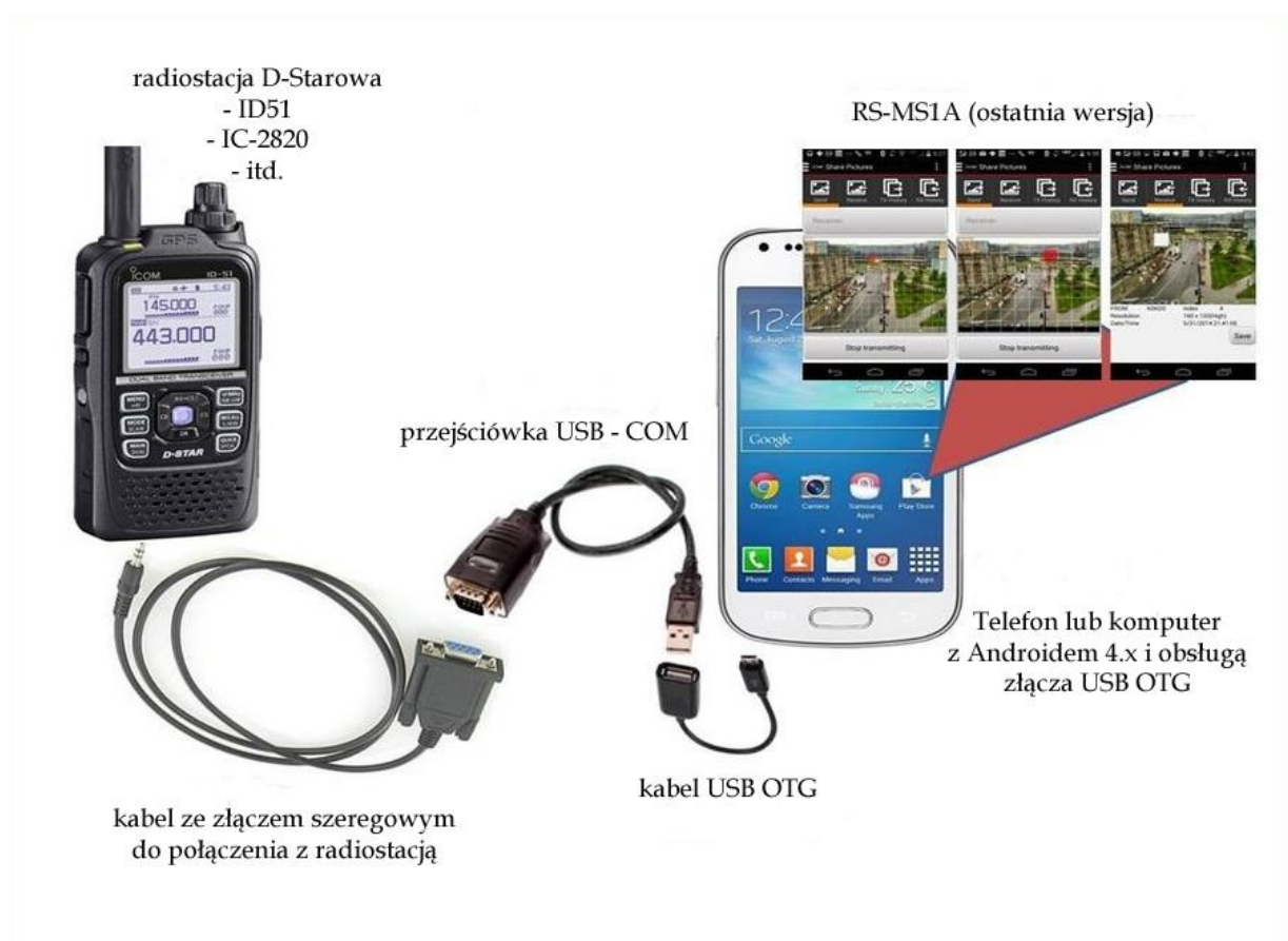
Rys. 9.3.3. Współpraca RS-MS1A ze starszymi typami radiostacji.
