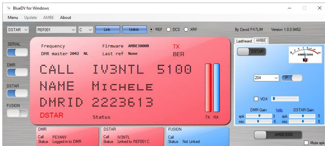
Rys. 11.10. Program „BlueDV” pozwala na korzystanie z reflektorów DXEXTRA, DPLUS i DCS w systemie D-STAR, sieci Brandmeister i DMR+ w DMR oraz reflektorów YSF i FCS w sieci C4FM. Pracuje on pod wersjami Windows od 7 wwyż obsługując mikroprzezienniki DVMEGA i wokoder DVStick 30.
