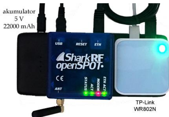
Fot. 11.12. Podręczny mikroprzeziennik dla cyfrowego głosu z zasilaniem akumulatorowym i przeziennikiem WiFi zapewniającym połączenie ethernetowe
